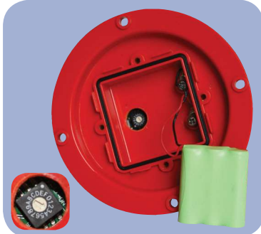
Los códigos de ritmos se seleccionan mediante un interruptor interno localizado en el interior de la batería
